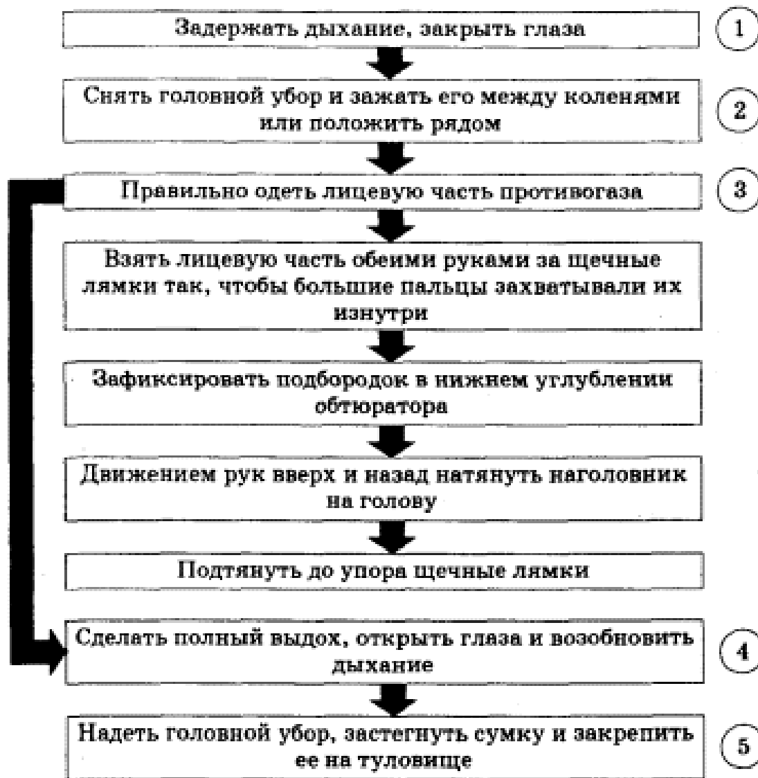
Схема 16. Перевод противогаза в «боевое» положение
